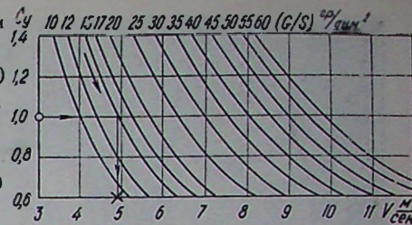
Рис. 3. График для определения скорости полета модели по данным c_y и \frac{G}{S} .
