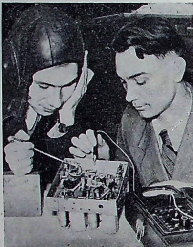
Рационализаторы Тамбовского областного аэроклуба старший техник по радио А. Корогодов (справа) и начальник радиостанции Ю. Шмелев возле сконструированного ими радиоприемника для планера «Пионер».
