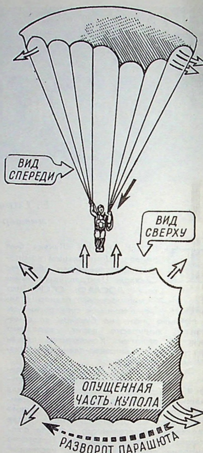
Рис. 1. Схема разворота парашюта с квадратным куполом.
