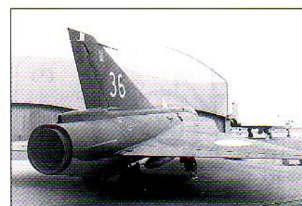
Хвостовая часть истребителя J-35B. Видны: сопло двигателя, над ним – контейнер парашюта (его створки раскрываются в стороны). Выше – руль поворота с аэродинамической компенсацией. В канале руля направления бустер не ставился. На борту хвостовой части установлен воздухозаборник для обдува сопла. Позже в задней части воздухозаборников установили устройства для отстрела ИК ловушек
