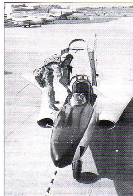
Экспериментальный самолет 210B, был сделан в масштабе 7/10 от проектируемого J-35. Он имел боковые воздухозаборники и большую переднюю часть для установки РЛС. Самолет сделал 1000 полетов, и дал богатый материал разработчикам
