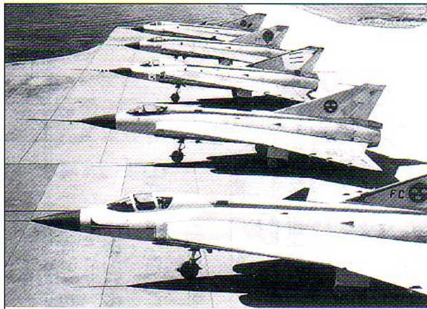
Первые пять серийных J-35A. Контейнер тормозного парашюта выступает за обрез фюзеляжа, а аэродинамические гребни выходят на верхнюю поверхность крыла. В дальнейшем гребни перделали и они были только снизу
