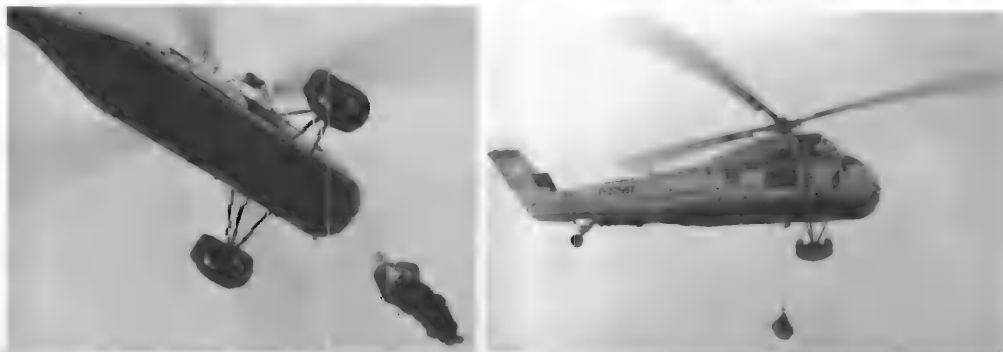
фото из отчёта ОКБ им. М.Л.Миля по испытаниям на S-58 гидрорубки BL-1315 для подъёма на борт человека или грузов
