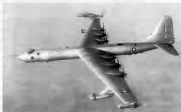
Консольная подвеска RF-84F «Тандерфлэш» к крылу самолета-носителя RB-36F
