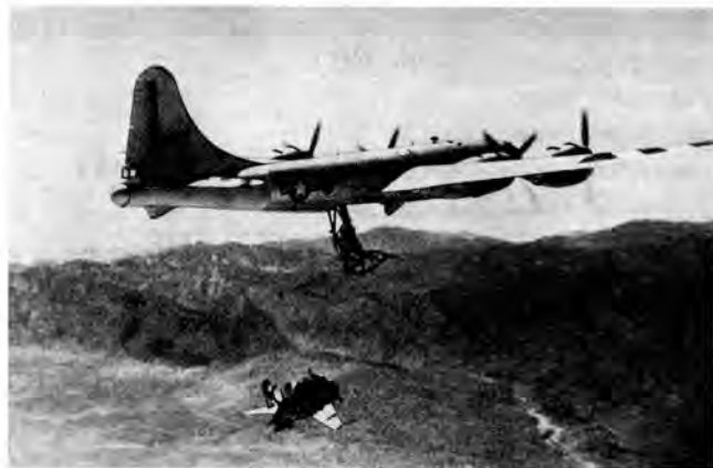
Подцепка «Гоблина» под самолет-носитель EB-29B.
