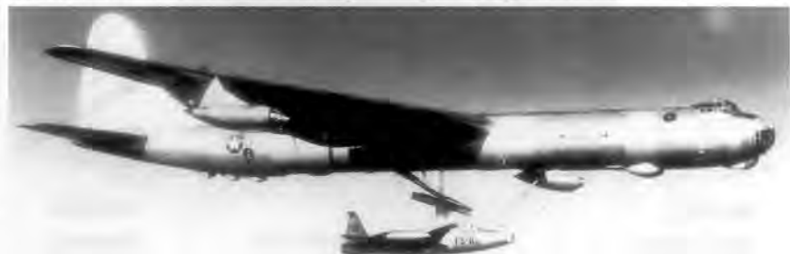
Подцепка F-84E «Тандерджет» под самолет-разведчик GRB-36
