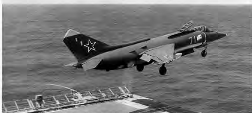
Короткий разбег позволял Як-38 и Як-38М взлетать с палубы с максимальным взлетным весом и боевой нагрузкой 1,7-2,0 т в любых атмосферных условиях Мирового океана. Кроме того, сокращался расход топлива на взлет и исключалось попадание горячих газов в воздухозаборники двигателей после отрыва от палубы.
