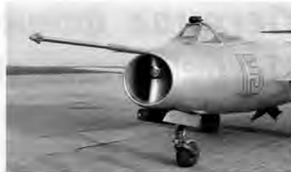
Положение «гарпуна» истребителя Як-25 в момент сцепки
