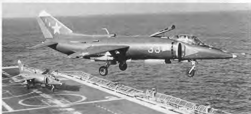
Вертикальный взлет пары Як-38 с блоками УБ-16, снаряженными 16 НУРС С-5. Такие НУРС могли эффективно использоваться для залповой стрельбы по небронированным наземным, надводным и маневрирующим воздушным целям.
