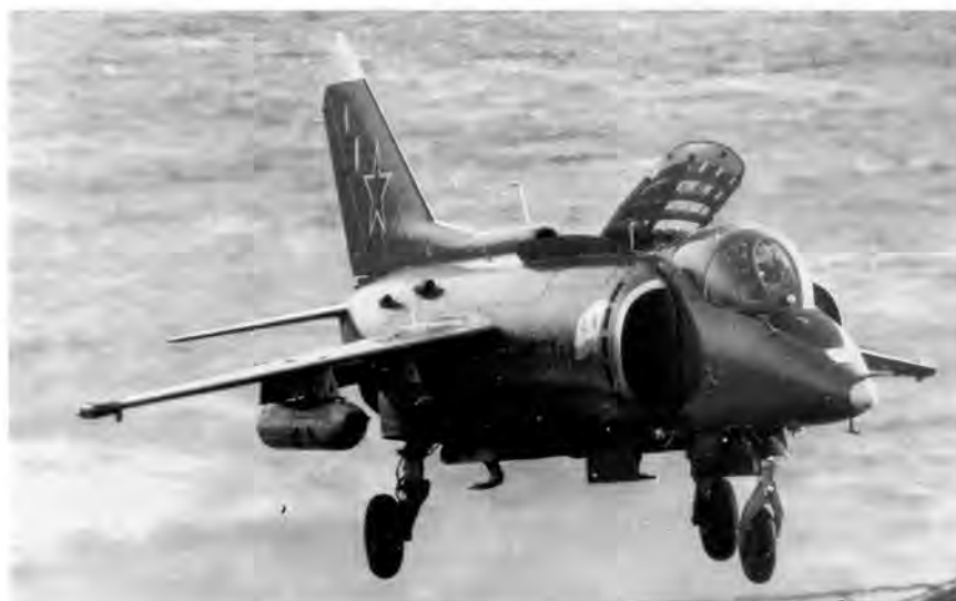
Як-38 с двумя пушечными контейнерами УПК-23-250 заходит на посадку. Снаряды пушки ГШ-23 пробивали броню до 15-мм, что позволяло уверенно поражать не только все небронированные, но и легкие бронированные цели.
