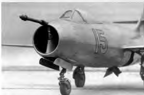
Истребитель Як-25, оснащенный вариантом «гарпуна» с шаровым шарниром
