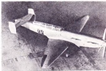
2. Вы видите первый в стране самолет с соосными винтами. Что вы знаете о нем и о его создателе? Какие еще самолеты с соосными винтами вам известны!
