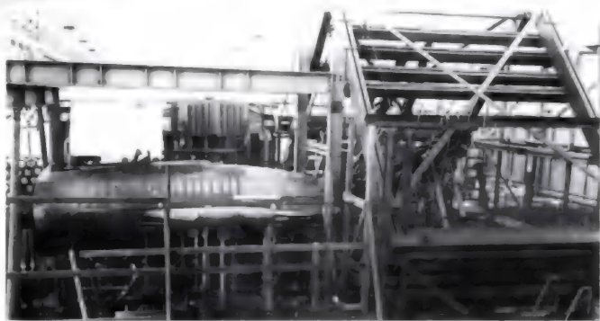
Планер самолета XFV-1 во время прочностных испытаний хвостового оперения
