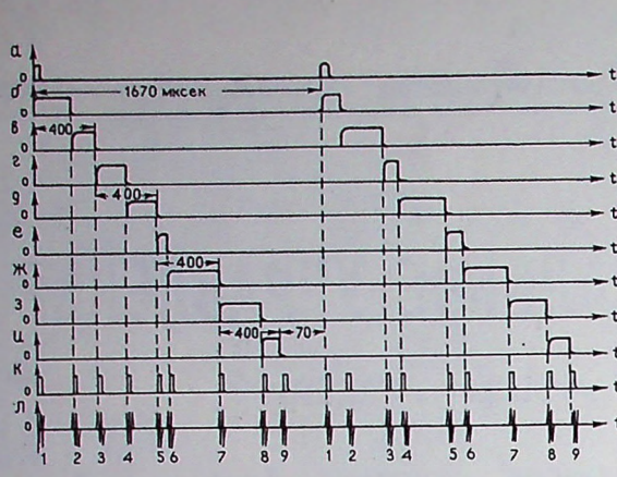
Рис. 3. Временные диаграммы блока временного кодирования (BVK).
