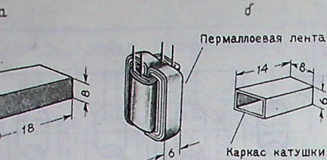
Рис. 9. Детали импульсного трансформатора: а — для передатчика; б — для передатчика и приемника.
