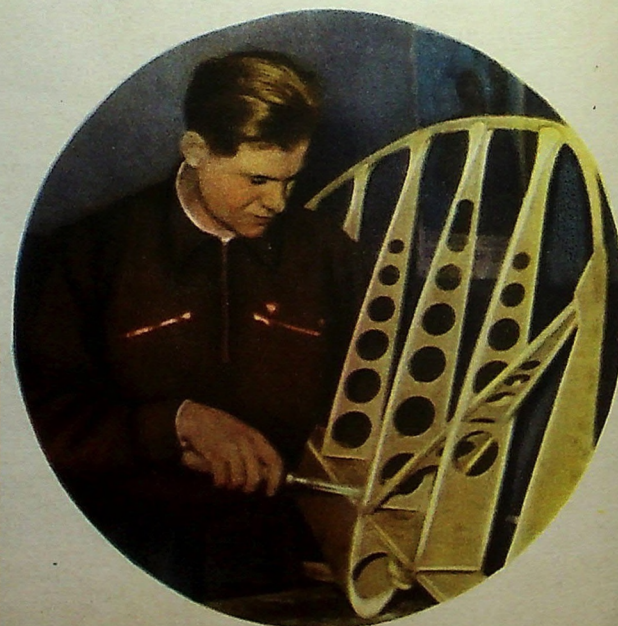
↓ Участвовать в постройке планера — дело заманчивое и почетное. На снимке: комсомолец-кружковец газорезчик завода Сергей Кудинов обрабатывает нервюру руля.
