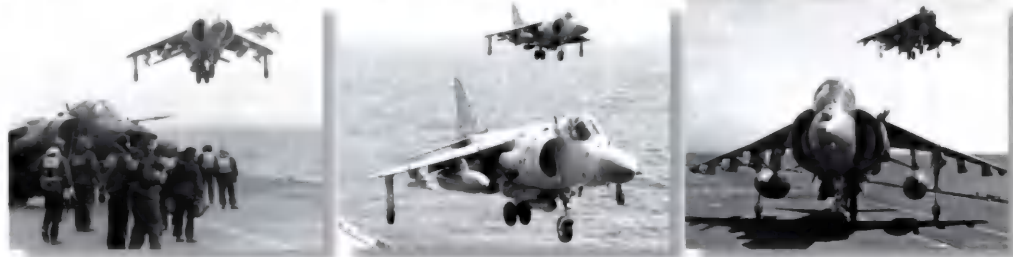
При загрузке полетной палубы самолетами и вертолетами, а также для повышения темпа групповой вертикальной посадки, «Харриеры» часто выполняли заход на посадку вдоль левого борта авианосца или авианесущего УДК на небольшом расстоянии друг от друга и после торможения производили вертикальную посадку на свободные площадки, смещаясь вправо до осевой линии ВПП. На снимках – вертикальная посадка английских «Си Харриеров» FRS.1 и FRS.2 на английские авианосцы и «Харриеров» AV-8B из КМП США на УДК
