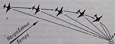
Рис. 6. Выполнение полета на радиостанцию с помощью самолетного радиопеленгатора.
