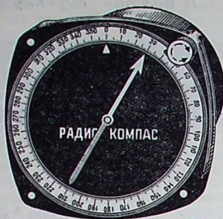
Рис. 5. Индикатор автоматического радиокомпас (АРК).
