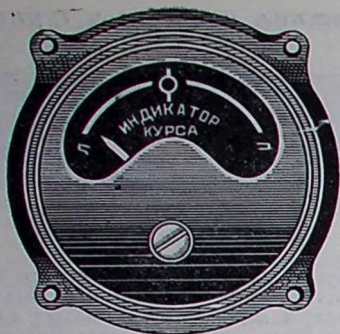
Рис. 4. Индикатор радиополукомпас (РПК).
