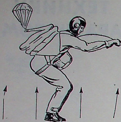
Рис. 5. При открытии парашюта в таком положении затенения не происходит.
