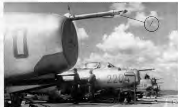
Подготовка бомбардировщиков Ту-4 и истребителей МиГ-15бис к испытаниям системы буксировки «Бурлаки». Аэродром Зябровка, лето 1952 г.
