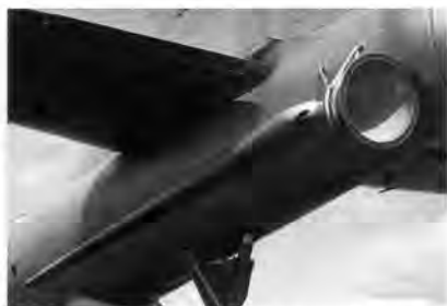
Размещение конуса-приёмника на бомбардировщике Ту-4
