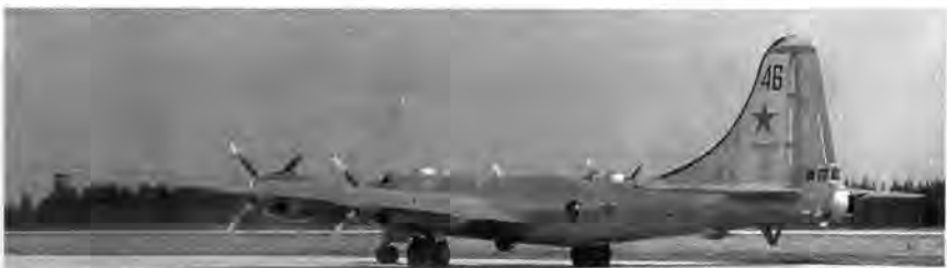
Бомбардировщик Ту-4 №221001, оборудованный системой буксировки
