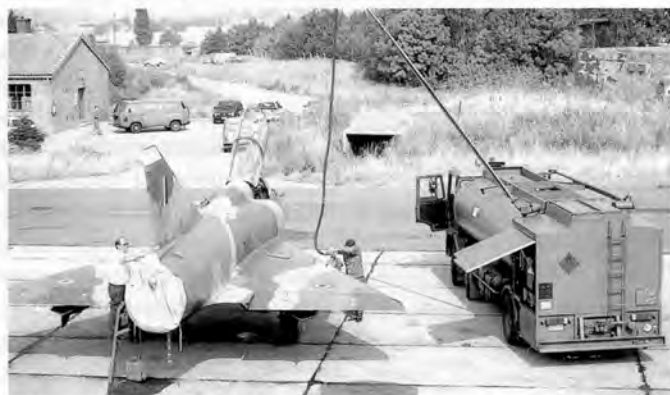
Заправка подвесных топливных баков на «Мираж» 5BD
