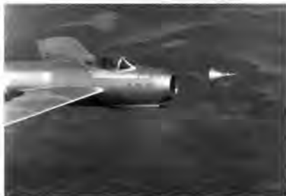
Момент сцепки истребителя МиГ-15бис с конусом-приёмником
