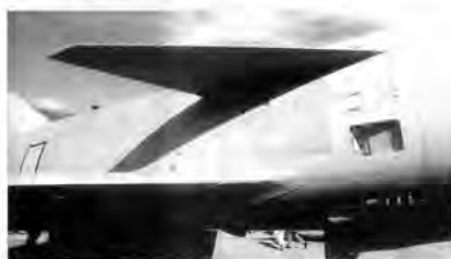
Переднее горизонтальное оперение истребителя «Мираж» III
