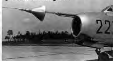
Автосцепка «гарпуна» с буксировочным конусом
