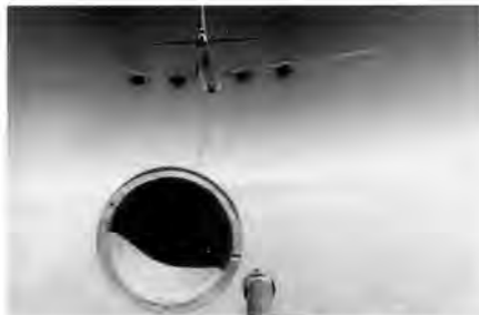
Подход истребителя МиГ-15бис к конусу-приёмнику для сцепки. Снимок сделан с истребителя
