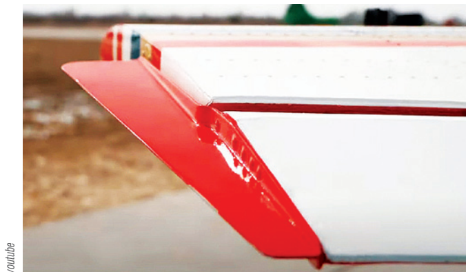
Як-52 с «псевдонимом» СП-52М имел элероны с роговой компенсацией (на фото внизу)
