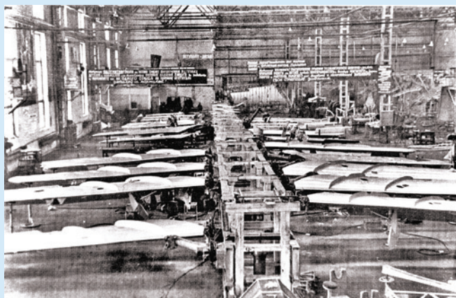
Цех № 3. Линия внестапельной сборки крыла МиГ-17, 1950-е годы
