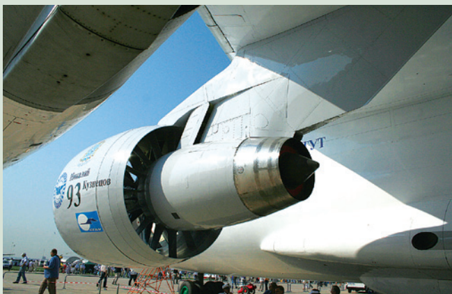
Двигатель НК-93 на крыле Ил-76ЛЛ на Международном авиационно-космическом салоне
