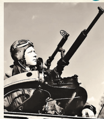
Средняя установка с пулеметом ШКАС на бомбардировщике СБ
