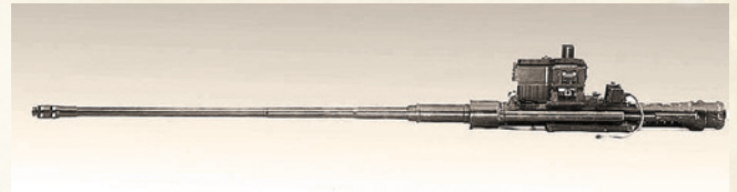
Пушка НС-45 с дульным тормозом устанавливалась только на истребители Як-9К
