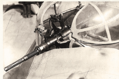
Пулемет УльтраШКАС на верхней установке бомбардировщика ДБ-3
