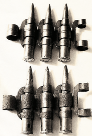
Патроны пулемета ШКАС с закраиной на гильзе
