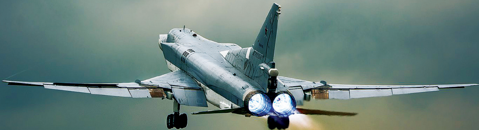
Сверхзвуковой ракетносец-бомбардировщик Ту-22М3 с двигателями НК-25
