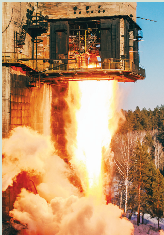
Стенд для испытаний ракетных двигателей на СНТК им. Н.Д. Кузнецова
