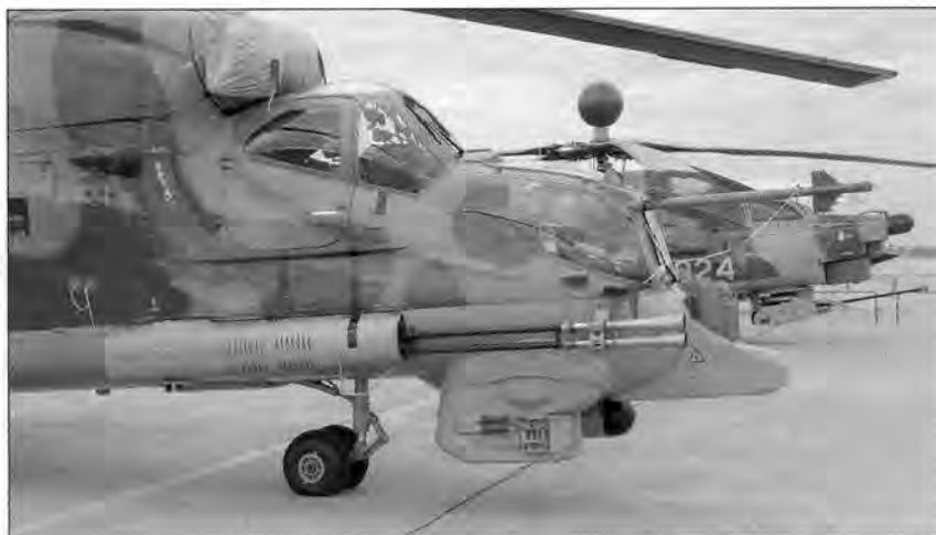
Модernизированный вертолет Ми-24ПН борт 36-жёлтый. Видна дополнительная аппаратура системы наведения управляемого оружия
