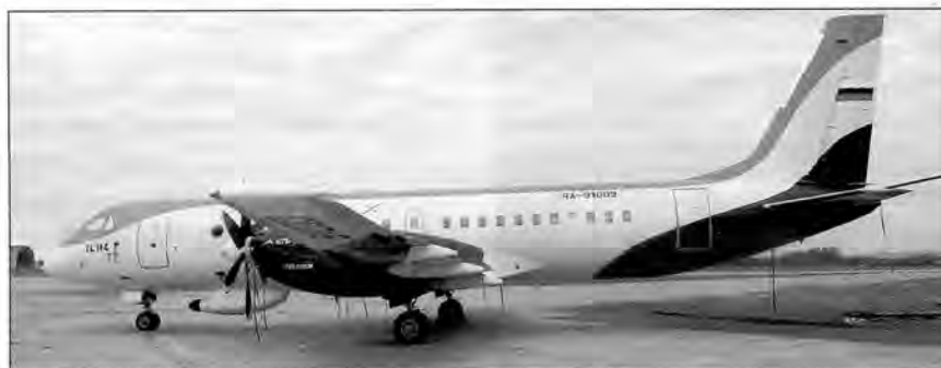
Ил-114ЛЛРА-91003 – летающая лаборатория радиотехнической фирмы «Радар-ММС». Под фюзеляжем виден обтекатель спец аппаратуры
