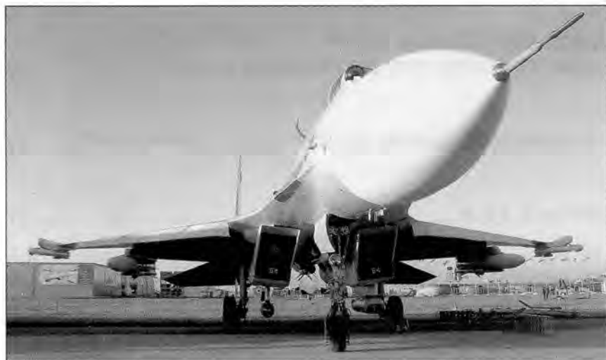
Модернизированный истребитель Су-27СКМ (борт 04-красный) в наземной экспозиции. На пилонах – ракеты «воздух-поверхность» Х-31 и контейнеры системы наведения АПК-9
