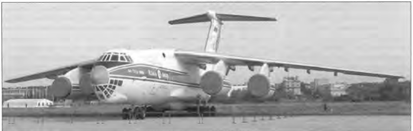
Ил-76ТД-90ВД борт 76950 авиакомпании «Волга-Днепр», оснащённый двигателями ПС-90А-76 (вместо двигателей Д-30КП, стоящих на базовом варианте)
