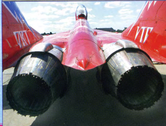
МиГ-29ОВТ - вид на сопла двигателей РД-33 с отклоняемым вектором тяги
