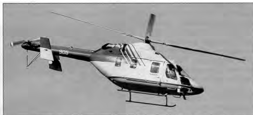
Очередной опытный экземпляр (борт 905-белый), оснащенный грузопассажирской кабиной, представляет собой экземпляр базового варианта с двигателями Роллс-Ройс 250С30
