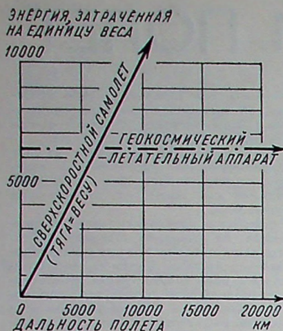
Рис. 2. Зависимость между энергией, затрачиваемой на единицу веса, и дальностью полета для геокосмического летательного аппарата и сверхскоростного самолета, у которого сила тяги равна его весу.
