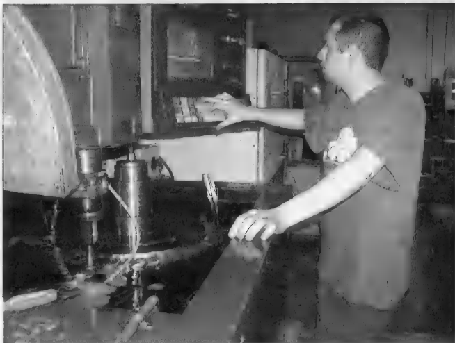
Рис. 5. Обработка моноколеса на станке мод. A65R фирмы «SODICK» (Япония)
