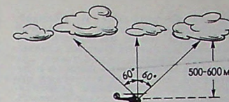
Рис. 2. Наилучшее положение экипажа-разведчика при определении количества облаков.
