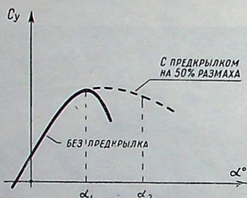
Рис. 3. Влияние предкрылка на величину C_y при больших углах атаки.
