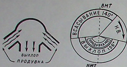
Рис. 4. Схема продувки и диаграмма газораспределения двигателя.
