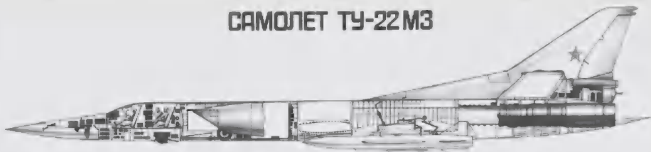
Схема размещения экипажа, оборудования и вооружения в фюзеляже самолета Ту-22МЗ
