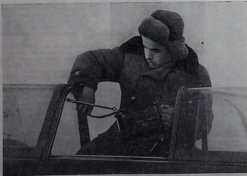
Перед полетом А. Г. Афанасьева. Технический комиссар В. И. Шустов устанавливает на самолете барограф.
