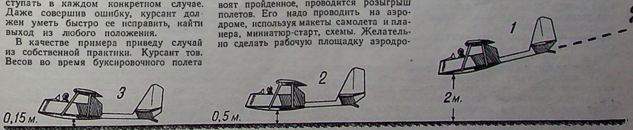
Профиль посадки планера. 1 — начало выравнивания — на высоте 2 м. 2 — выдерживание — на высоте 0,5 м. 3 — трехточечное положение — на высоте 0,15 м.
