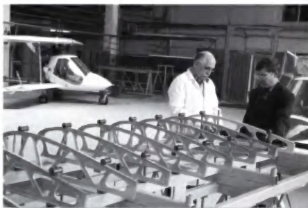
Изготовление крыла самолета МАИ-223
