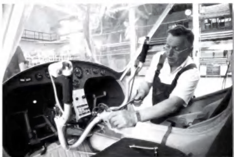
Монтаж систем управления самолета Авиатика 890У
