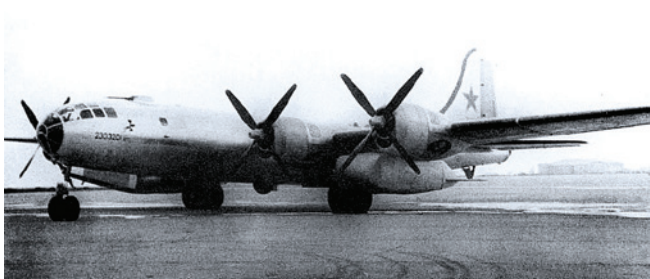
Ту-4Д с десантными кабинами П-90 под крылом
