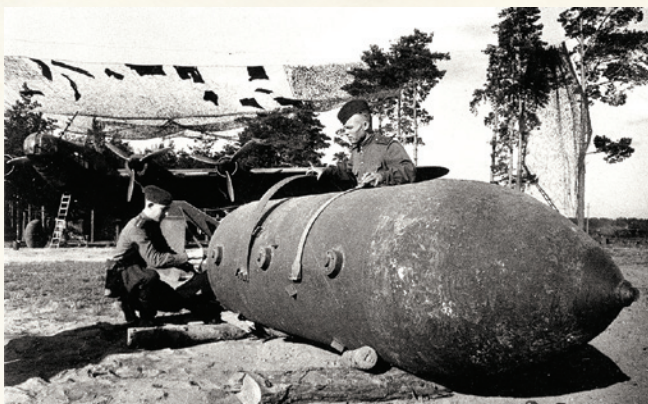
Оружейники 746-го ап дд готовят 5-тонную авиабомбу ФАБ-5000 к подвеске на бомбардировщик Пе-8
