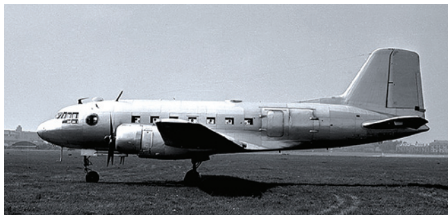
Опытный Ил-14Т; хорошо видна грузовая дверь
