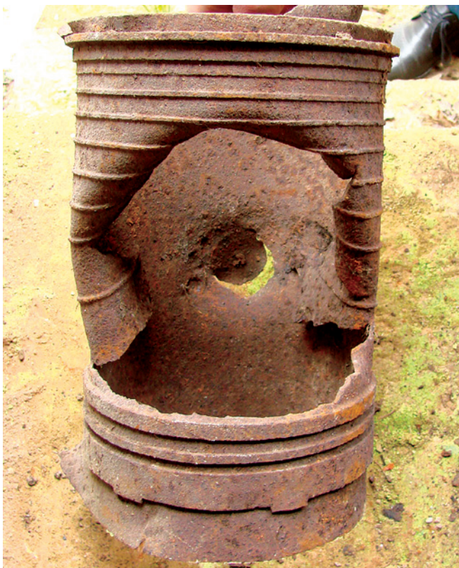
Рваное сквозное отверстие предположительно от разрывного снаряда авиационной пушки в одном из сохранившихся стаканов цилиндров двигателя АМ-35
