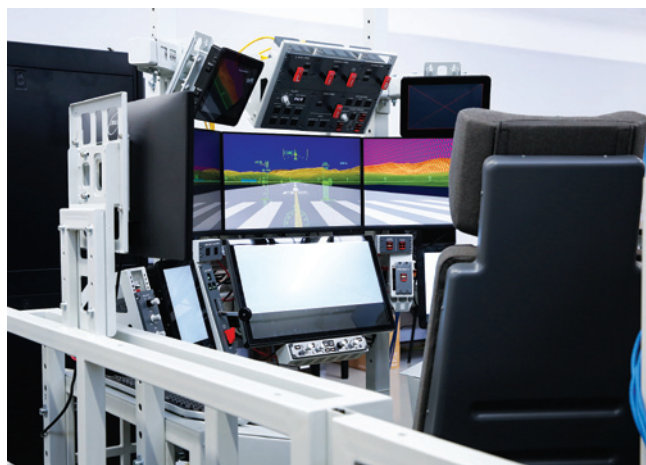
Комплексный полунатурный стенд-демонстратор технологий БРЭО и самолетных систем сверхзвукового гражданского самолета с использованием искусственного интеллекта
