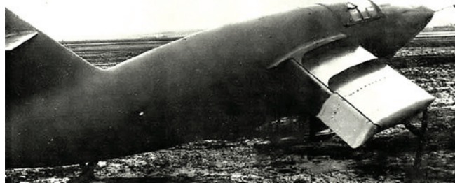
Экспериментальный ракетный самолёт «5» на испытаниях в варианте планера
