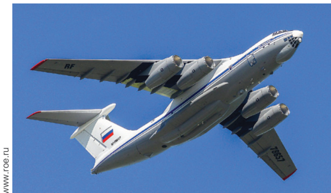
Ил-76МД-90А RF-78657. Видны двигатели ПС-90А-76 и «шарик» ГОЭС под носом
