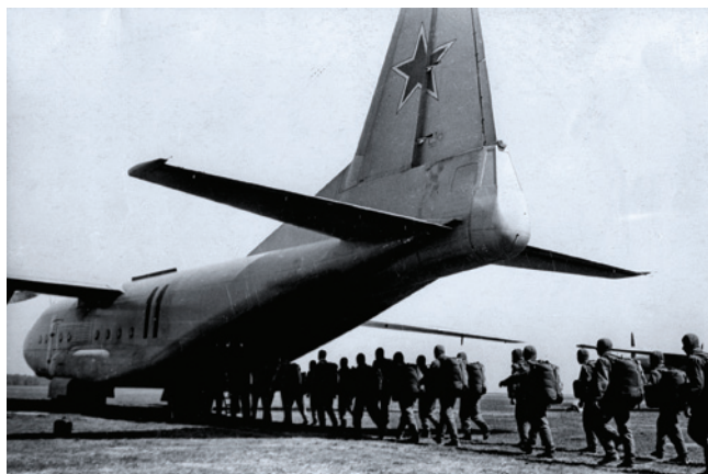
Посадка десантников в Ан-8. Турель ДБ-65У демонтирована, а место её установки зашито металлом, как у гражданских Ан-8
