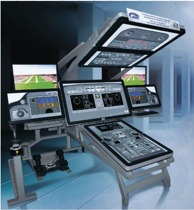
Стенд прототипирования информационно-управляющего поля кабины экипажа самолета МС-21, 2010-е годы
