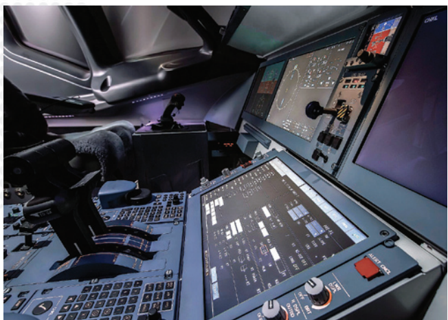
Полунатурный испытательный стенд интеграции, отработки и испытаний комплекса бортового оборудования самолета SJ-100 – «Электронная птица»
