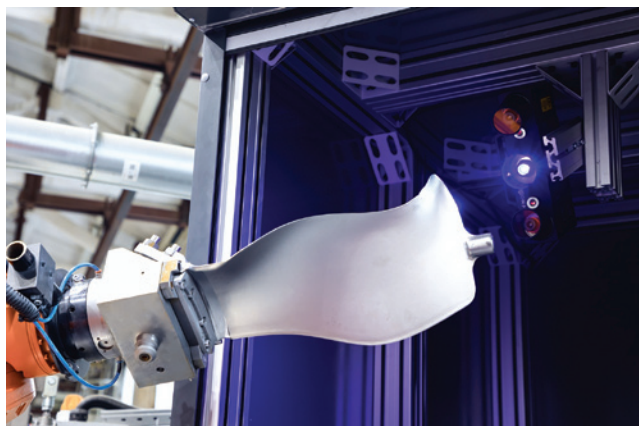
На предприятии «ОДК-Сатурн» для обработки лопаток двигателей создан роботизированный комплекс
