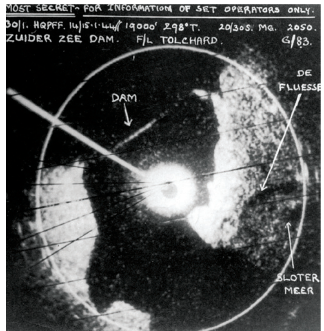
Изображение на индикаторе бортового радиолокатора H2S при нанесении удара по дамбам в Нидерландах
