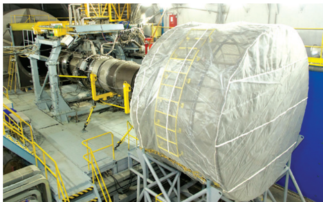
Испытания новейшего двигателя ПД-8 при максимальной нагрузке
