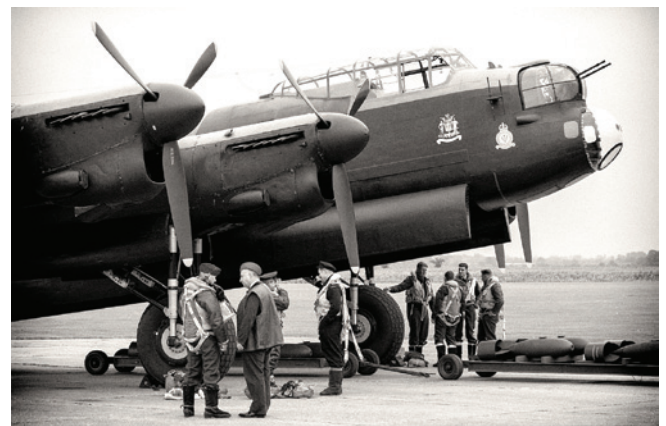
Бомбардировщик Lancaster представлял собой четырехмоторную версию двухмоторного предшественника – самолета Manchester
