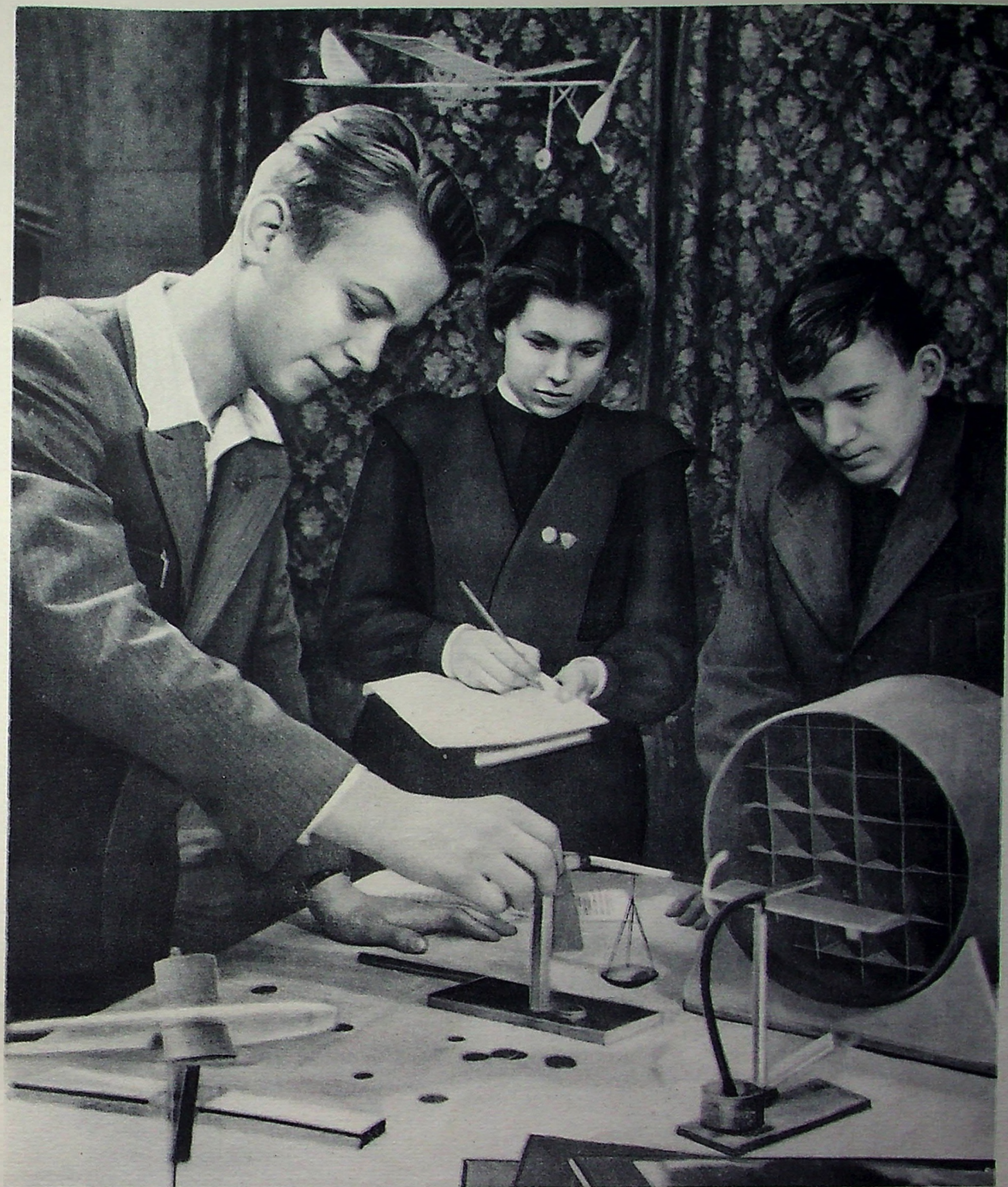
Дом пионеров Кировского района г. Москвы. Авиамodelисты Юра Савастический (слева), Ира Чебанова-Егоровская и Виктор Гаврилов производят продувку модели в настольной аэродинамической трубе.
