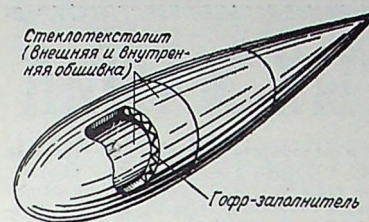
Рис. 2. Обшивка подвесных топливных баков из стеклотекстолита.
