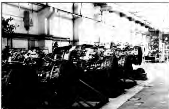
Основная продукция завода - авиационные ГТД АЛ-31Ф
