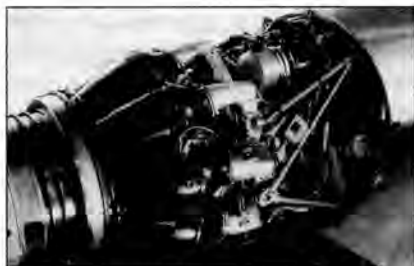
Установка двигателя ВК-1 на самолете МиГ-15 105015
