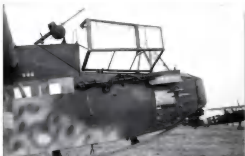
Передняя часть планера DFS-230. На крыше – пулемет MG 15, а на борту – MG 34 (оба кал. 7,9 мм). MG 34 предназначался для стрельбы в воздухе – у дульного среза установлен flame-защитный экран. На нем – номер 352, такой же как и на фюзеляже перед передней кромкой крыла. Виден иллюминатор под экраном. Перед лобовым стеклом заметна сетка прищелки. Штинцер, 1943 г. Немецкий архив
