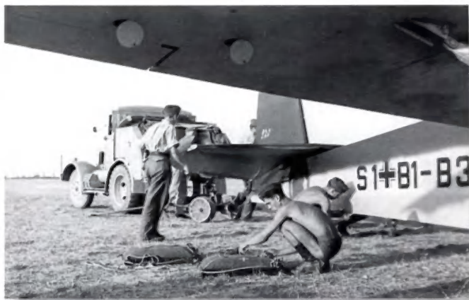
Италия. 1943 г., учебный центр. Техники готовятся установить тормозной парашют на планер. Лючки на крыле – открыты. На заднем плане – буксировочная тележка и буксировщик – итальянский автомобиль Ланц Бульдог. Штокер, 1943 г. Немецкий архив.
