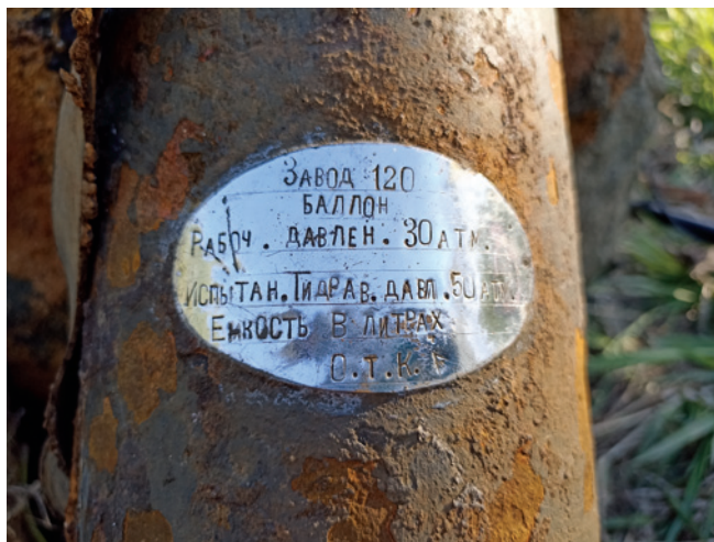
Баллон сжатого воздуха самолета Р-Зет из р. Истра. 2022 г.
