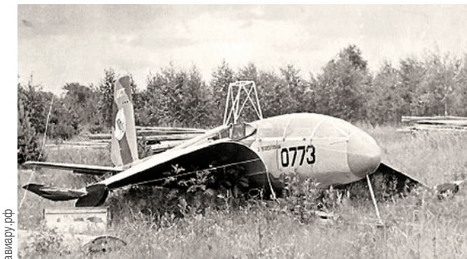
ЭС-2 «Шмель» – экраноплан на базе планера «Бланик»
