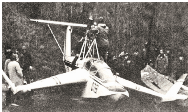
Экраноплан Т-501 на базе планера «Бланик»
