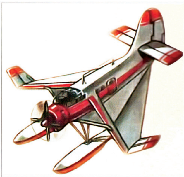
Проект экраноплана с мягким крылом на базе Ан-2В
