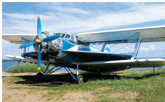
Экраноплан на базе Ан-2 с «третьим крылом»
