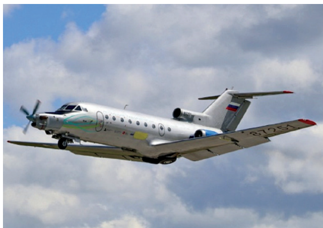
Летающая лаборатория на базе самолета Як-40 для испытаний полноразмерного демонстратора технологий гибридной силовой установки (ГСУ)
