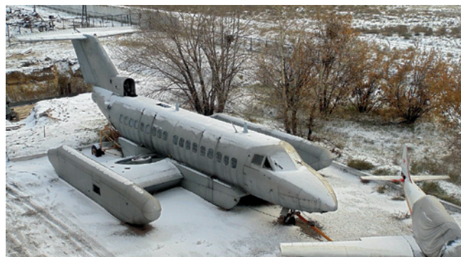
Экраноплан НВА-10 на базе агрегатов от самолётов L-410 и Як-40
