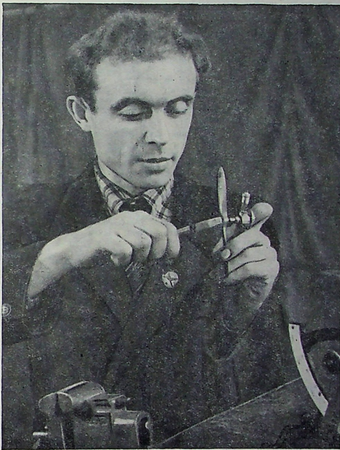
Авиамodelист Сергей Башкин регулирует сконструированный им миниатюрный дизельный моторчик для летающих моделей. Вес этого моторчика равен 20 граммам, а его рабочий объем не превышает 0,3 кубических сантиметра.
