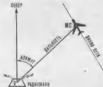
Рис. 2. Определение места самолета (МС) с помощью угломерно-дальномерной системы.
