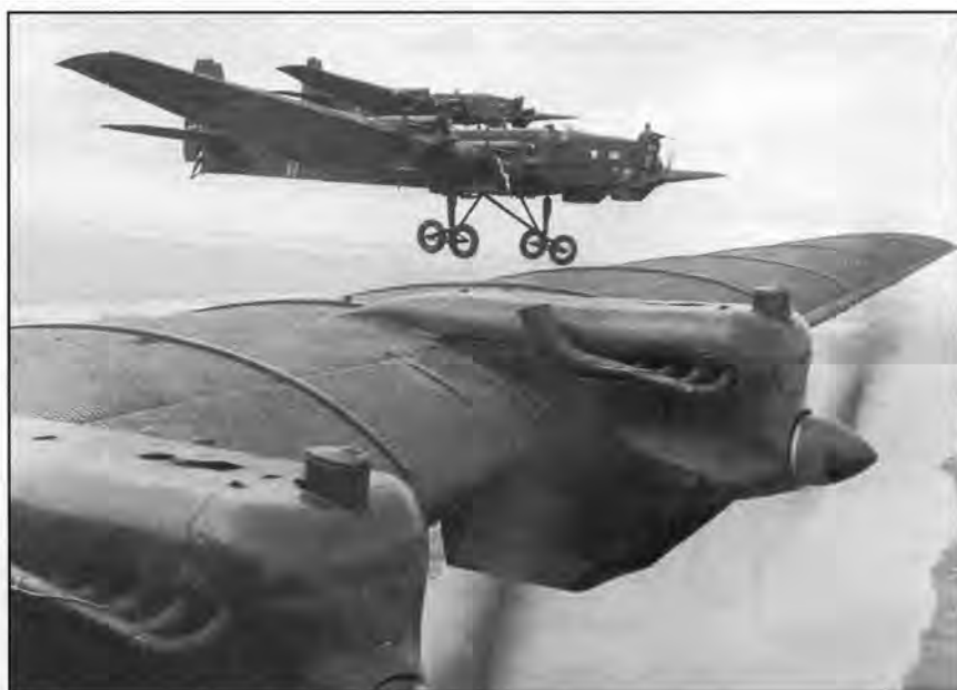
В полете - тяжелые бомбардировщики ТБ-3 с двигателями М-17Ф
