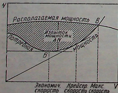
Рис. 2. График изменения мощности вертолета по скорости. V — скорость вертолета; N — мощность.
