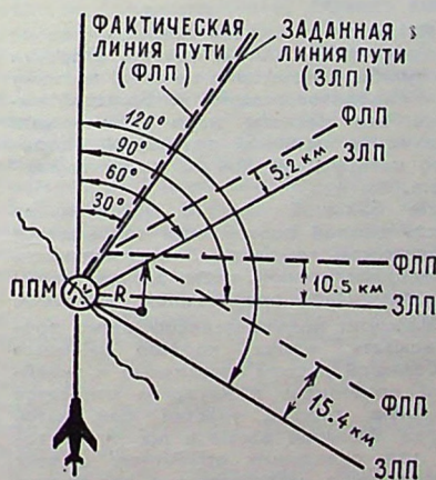
Рис. 1. Доворот на новый курс следования после выхода на поворотный пункт маршрута (ППМ). (Скорость самолета 700 км/час, крен при довороте 20°.)
