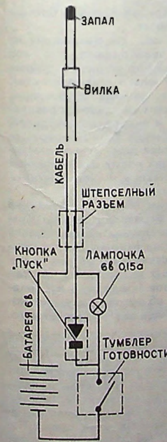
Рис. 1. Электрическая схема пульта запуска.
