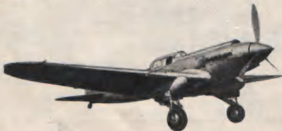
Двухместный штурмовик ЦКБ-55 № 1 с мотором АМ-35.
