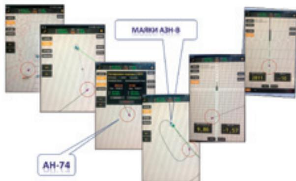
**Рис. 8. Отображение информации АЗН-В на электронном планшете пилота самолета Ан-74**
