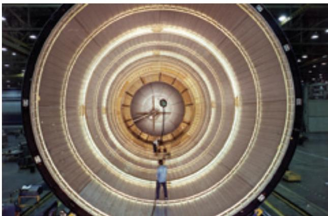
**Оболочка внешнего топливного бака МТКК изнутри**
