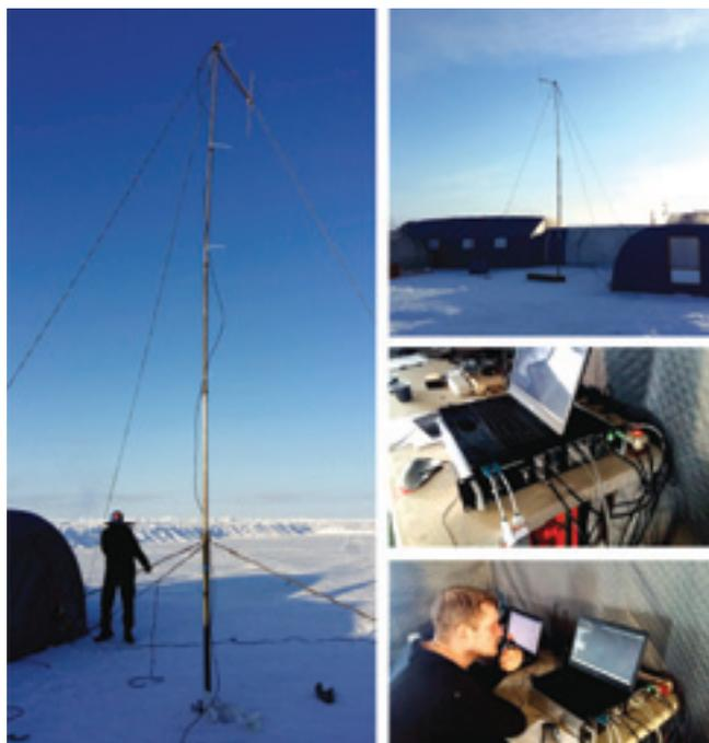
**Рис. 5. Оборудование АЗН-В на аэродроме Барнео**
