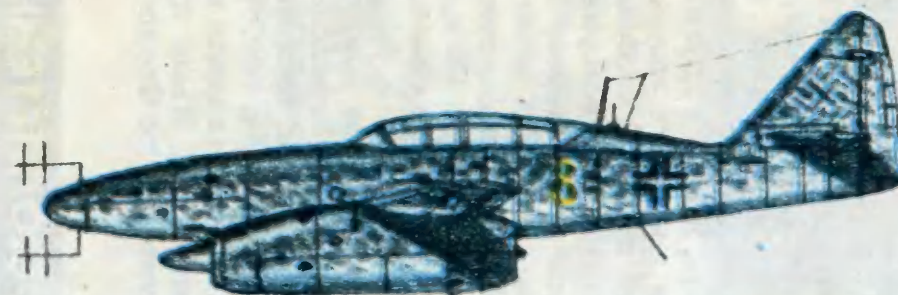
Ночной истребитель Мессершмитт Me- 262 B-2 (оборудован радиолокатором).
