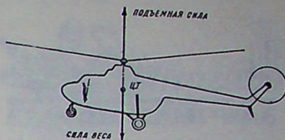
Рис. 5. Положение ручки управления при задней центровке вертолета.
