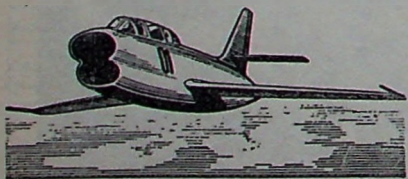
Рис. 1. Самолет «Мистэр» IV с радиолокатором, установленным над воздухозаборником.
