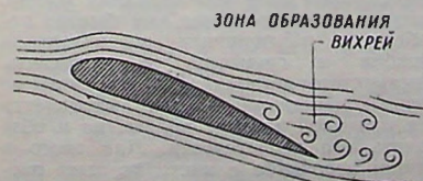
Рис. 5. Обтекание крыла с отрывом струй и вихреобразованием при больших (закритических) углах атаки.
