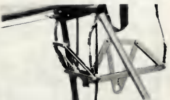
Параллелограммный механизм на одном из дельтапланов.
