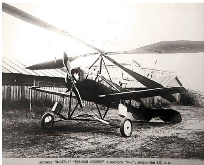
Автожир "КАСКИНГ-1" "КАСКИНГ ИНЖЕНЕР" с мотором "М-2", мощность 120 л.с.
