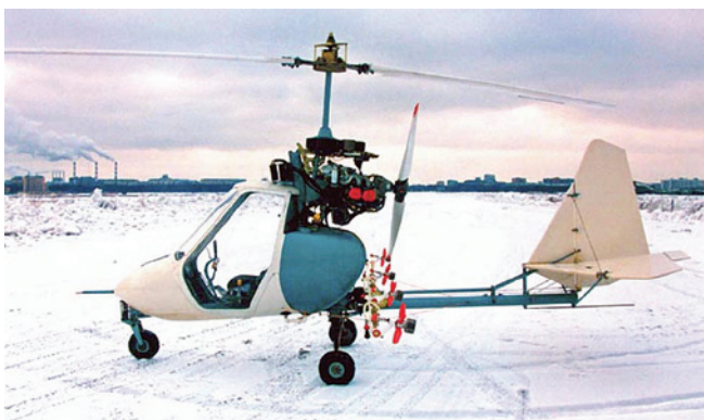
Два снимка автожира МАИ-205 с аппаратурой для авиахимработ
