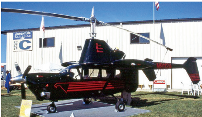
Автожир Revcon 6G, переделанный из самолёта Cessna 337
