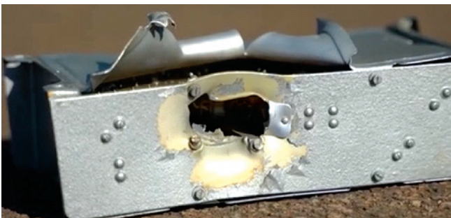
Поврежденный осколками один из электронных блоков Ми-24 «Акулы»
