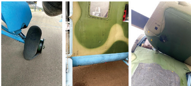
Повреждения Ми-2П. Пробитое пулей колесо Ми-24. Попадание крупнокалиберной пули 12,7 в броню капота двигателя. Колесо; борт 7,62; бронебойная пуля 12,7
