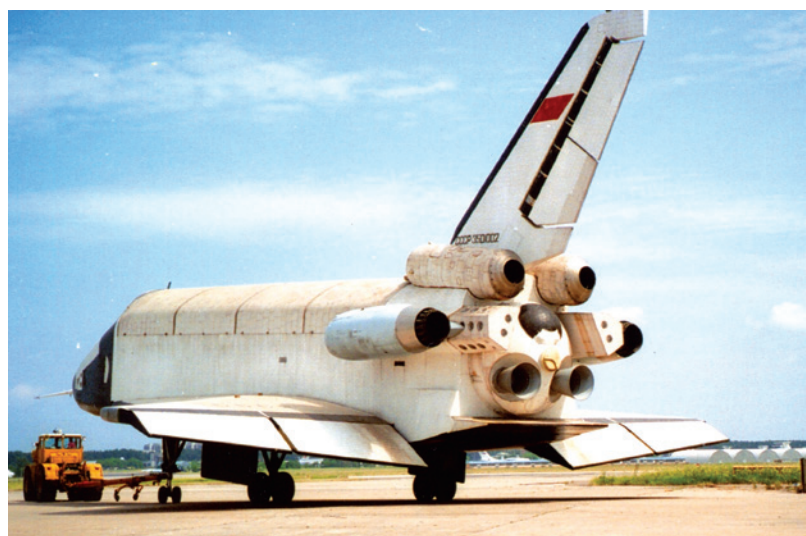
Б7С-002 – это полноразмерный самолёт – аналог «Бурана», созданный именно для отработки взлёта и посадки (в том числе в автоматическом режиме)
