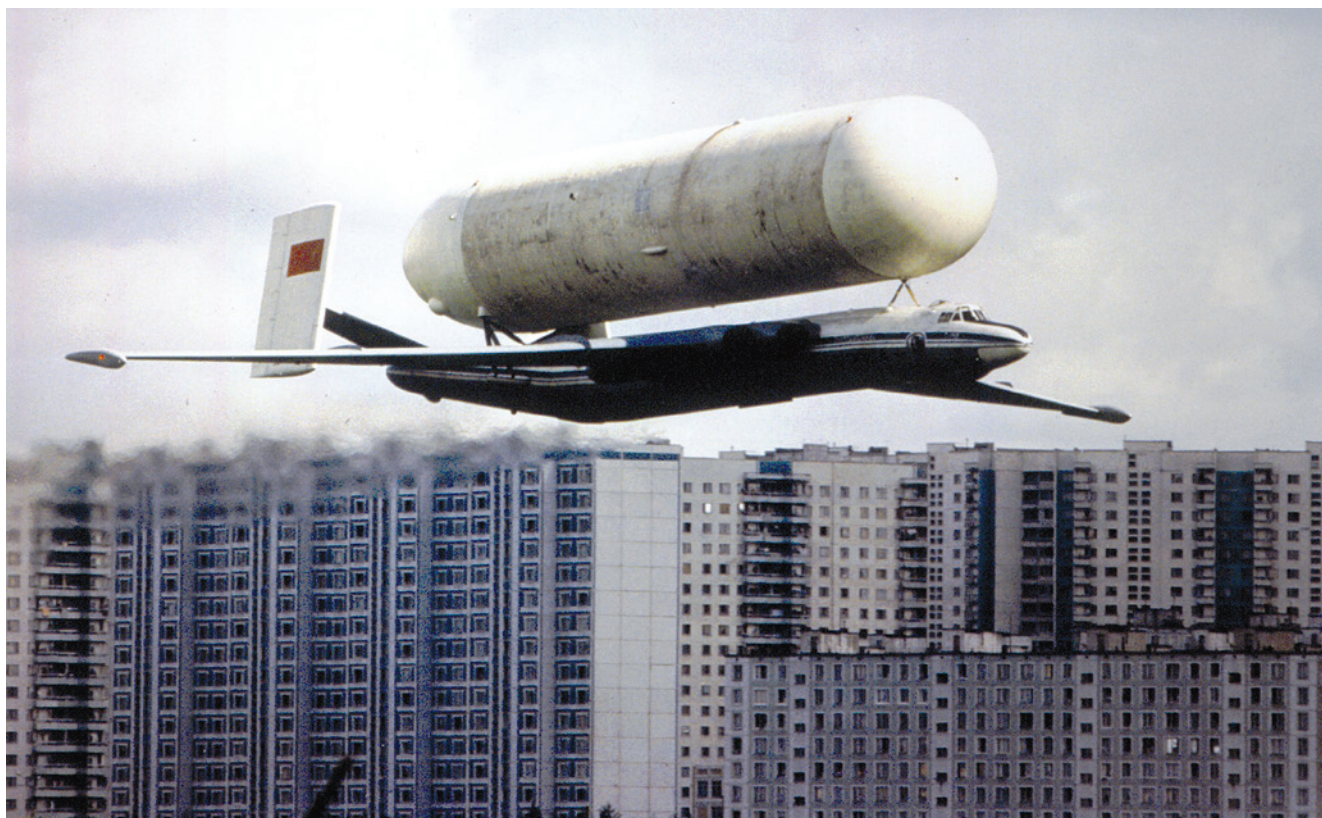
Самолет-транспортёрщик ЗМ-Т в комплектации с водородным баком центральной ступени ракеты-носителя «Энергия»
