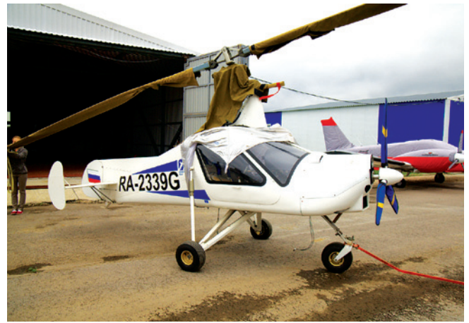
МАИ-208 с новым оперением и шасси (2015 г.). Ниже – он же в 2017 г. с килевыми шайбами
