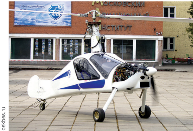
Автожир МАИ-208 в исходном виде (вверху) и с доработанным вертикальным оперением
