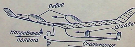
Рис. 3. Схема действия ребер, шайб и поперечного V крыла.
