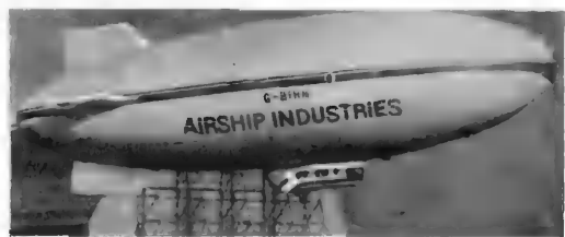
Общий вид дирижабля «Скайшип-500» у эллинга в Кардигтоне. Длина — 52 м. Максимальный диаметр — 14 м. Объем — 5153 м 3 . Максимальная скорость — 101 км/ч. Крейсерская —
