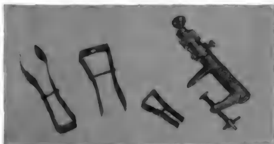
Струбцина и набор «подков» — держатели для деталей модели.
