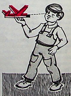
Рис. 3. Если, взглянув на модель спереди, ты заметишь, что одно крыло шире, это значит больше его угол установки, то есть угол между плоскостью крыла и верхней линией фюзеляжа.
