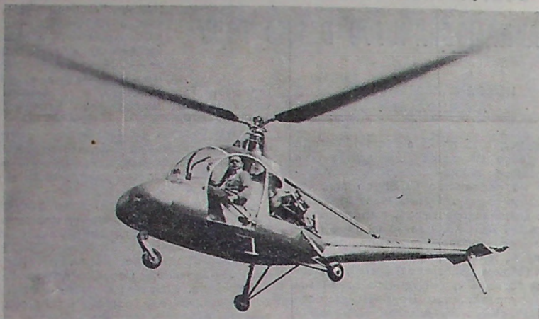
В Чехословацкой Республике начал серийный выпуск первого отечественного вертолета марки НС-2. Максимальная скорость вертолета 135 километров в час, наибольшая высота полета 3200 метров. На снимке: двухместный вертолет НС-2 во время полета.
