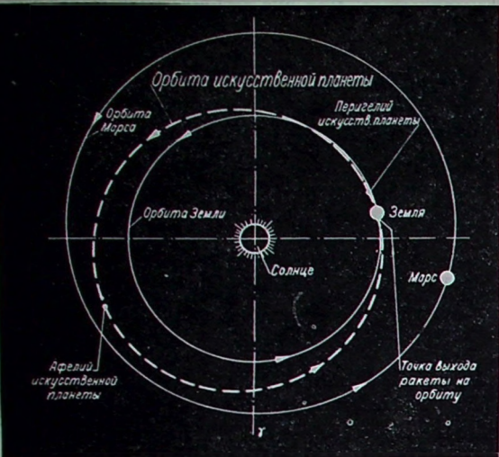
Схема расчетной орбиты искусственной планеты относительно Солнца (планеты на схеме показаны в момент максимального сближения ракеты с Луной).
